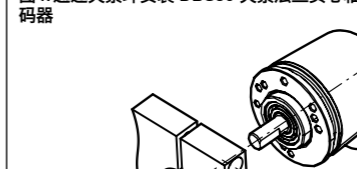
图4: 通过夹紧环安装 DBS36 夹紧法兰实心轴型编码器
