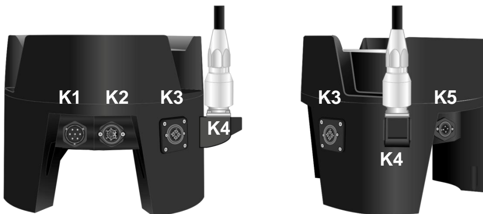
Abb. 3.3: Schnittstellenanordnung des X-zone Com.
