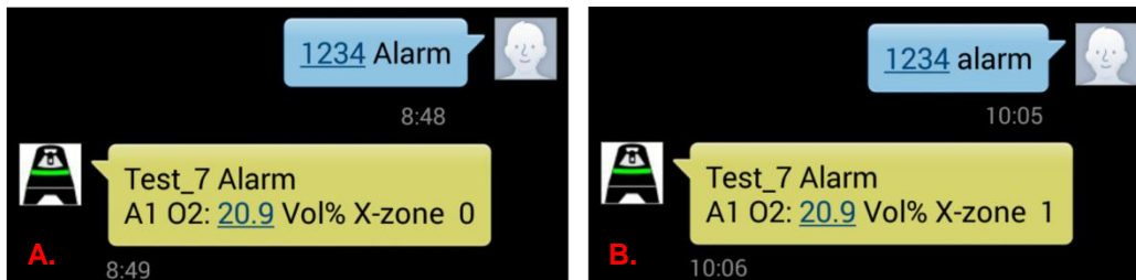
Fig. 7.10: Ecran d'un Smartphone après une demande d'alarme. La demande portait sur le X-zone Com "Test_7". Il y a une alarme A1 au niveau de l'oxygène. La valeur d'oxygène suivante porte sur la valeur O2 actuellement mesurée et non pas sur celle ayant entraîné l'alarme.
